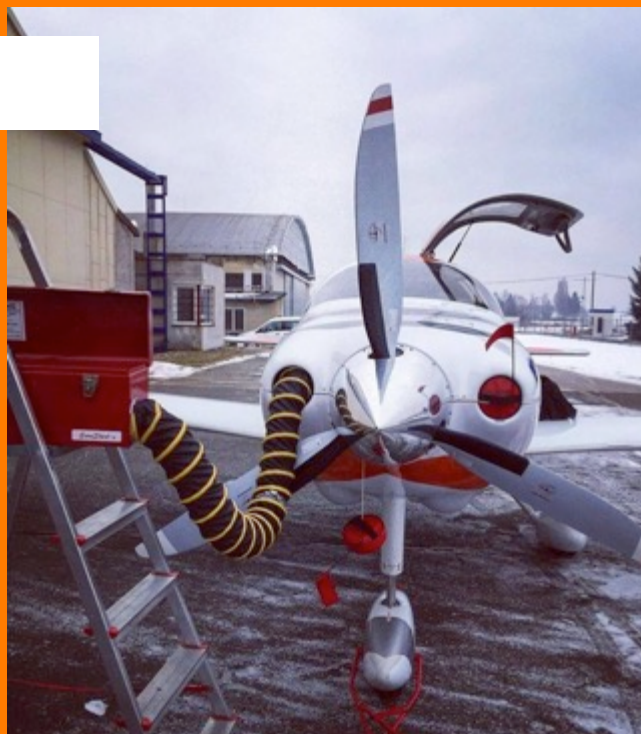
Předehtání (ruční protočení) motoru Již při teplotách pod +5°C
